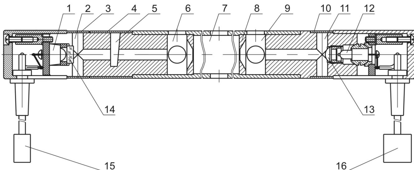
1- Фотодатчик (фотодиод); 2-Отверстие для очистки светофильтра; 3, 4-Шторка; 5-Гнездо для установки контрольного светофильтра; 6,9-Буферная камера; 7-Измерительная камера; 8-Диафрагма; 10-Шторка; 11-Отверстие для очистки оптической линзы; 12-Лампа; 13-Оптическая линза; 14-Светофильтр; 15, 16-Разъемы для подключения к плате обработки модуля контроля дымности
