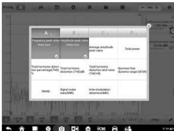
**Рисунок 7-85. Пример окна настройки измерений (спектральное представление)**
