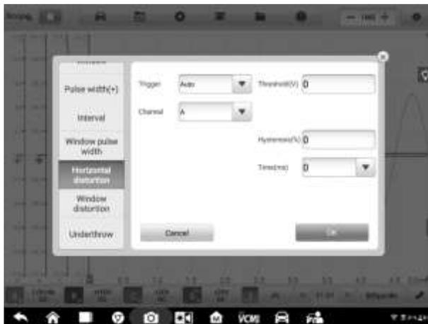
**Рисунок 7-74. Пример окна параметров горизонтального искажения**
