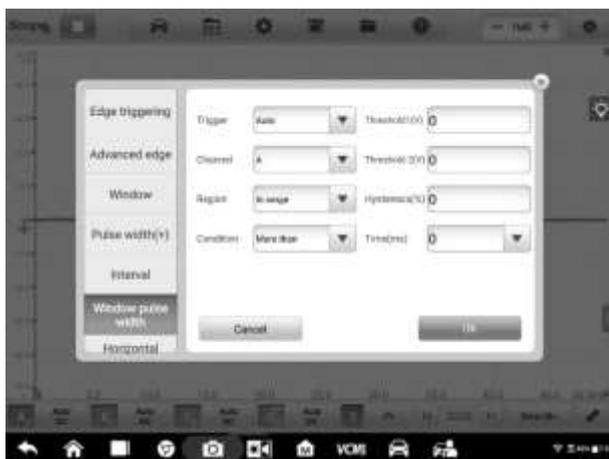
**Рисунок 7-73. Пример окна параметров диапазона ширины импульсов**
