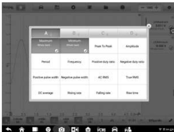
**Рисунок 7-82. Пример окна настройки измерения**
