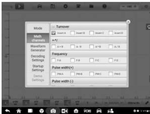
Рисунок 7-19. Первый пример окна настройки математического канала
