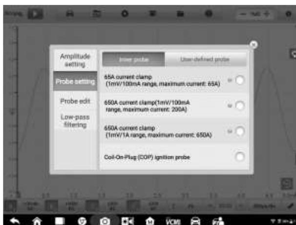
Рисунок 7-53. Пример окна настройки стандартного щупа
