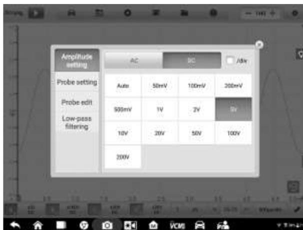
**Рисунок 7-49. Пример окна настройки амплитуды (постоянное напряжение 5 В)**
