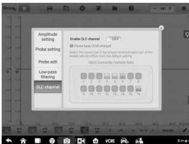
**Рисунок 7-61. Первый пример окна настройки канала DLC**
