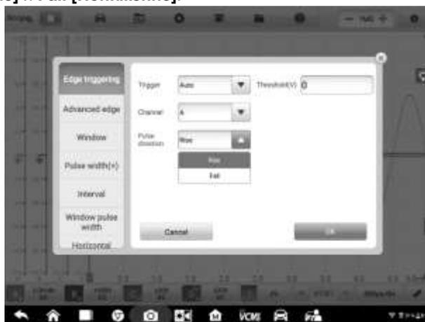
**Рисунок 7-68. Пример окна настройки направления импульса**
