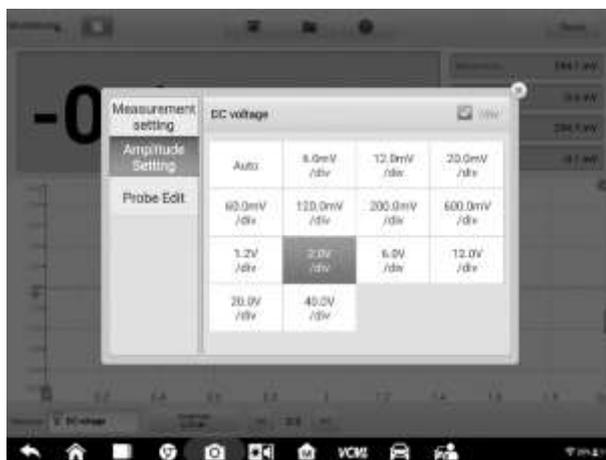
**Рисунок 7-18. Пример окна настройки амплитуды (постоянное напряжение 2,0 В/дел)**
