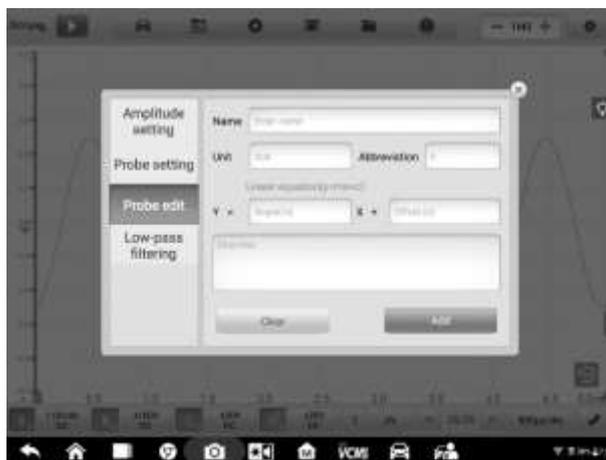
Рисунок 7-54. Первый пример окна изменения параметров щупа
