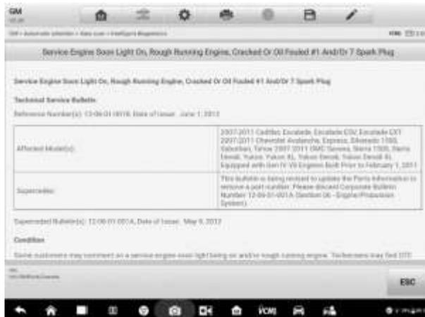
Рисунок 5-18. Пример окна, содержащего подробную информацию из бюллетеня технического обслуживания
