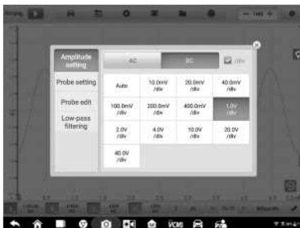
**Рисунок 7-51. Пример окна настройки амплитуды (постоянное напряжение 1,0 В/дел)**
