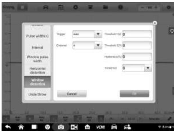
**Рисунок 7-75. Пример окна параметров искажения диапазона**
