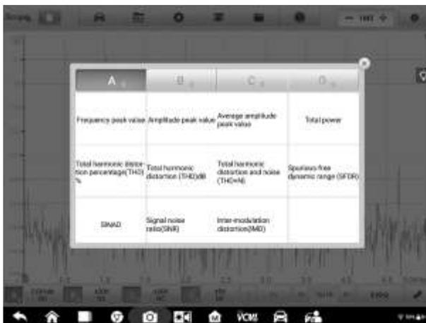
**Рисунок 7-81. Второй пример окна выбора процедуры измерения (спектральное представление)**
