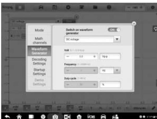
**Рисунок 7-21. Пример окна настройки генератора сигналов**
