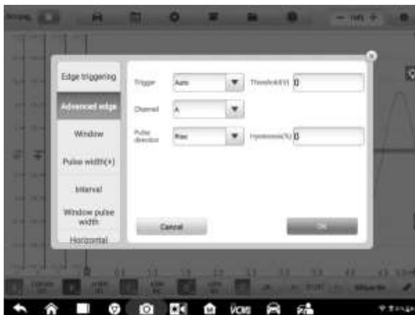
**Рисунок 7-69. Пример окна параметров расширенного порогового запуска**
