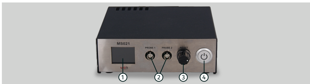
Rysunek 1. Ogólny widok urządzenia MS021: 1 - Ekran; 2 - Złącza do kabli diagnostycznych; 3 – Enkoder z przyciskiem; 4 - Przycisk zasilania.
