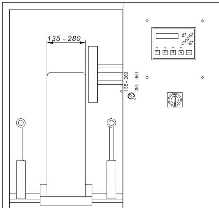
Положение **280-360** – ролик в спокойном положении (отодвинут) – для колес шириной от 280-360 мм
