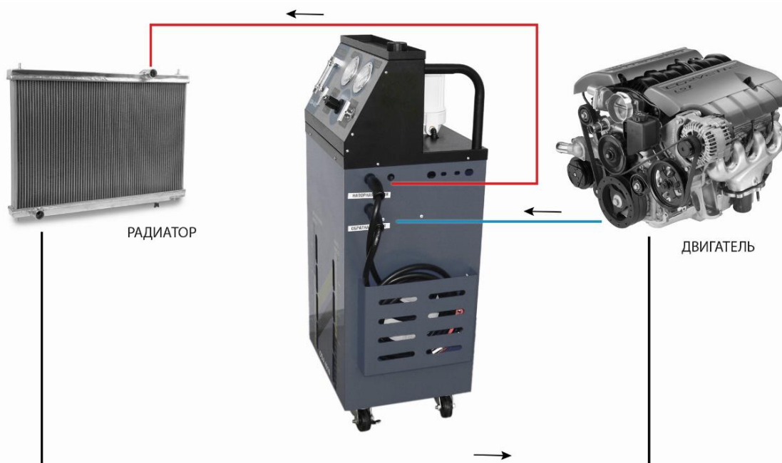
Рис. 3 Схема подключения изделия к системе охлаждения автомобиля
